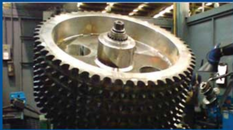
Sprocket sêxtuplo passo 240 de 56 dentes para Máquina de enrolamento de Correia Transportadora
