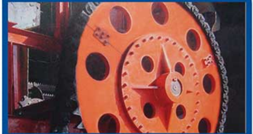
Sprocket em três seções com cubo desmontável para a Indústria Sucrialcooleira.
