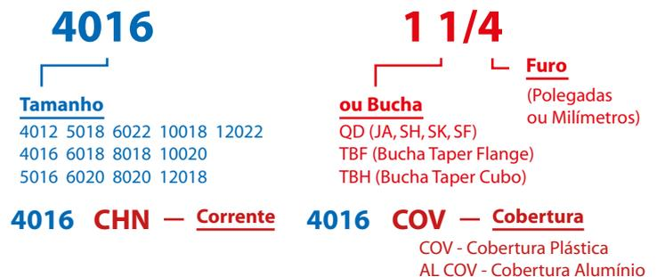
O conjunto completo do acoplamento Quadra-Flex consiste em 2 Cubos e um elemento elástico. Quando solicitar o "Cubo" especificar o tamanho do acoplamento, seguido do tipo de Cubo e Diâmetro do Furo. Quando solicitar o "Elemento Elástico" especificar o tamanho do acoplamento seguido das letras conforme nomenclatura do material desejado.
